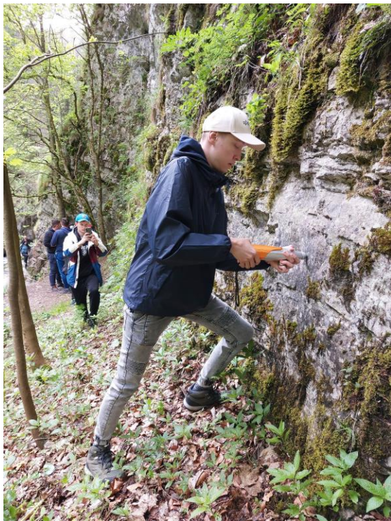
Prosiecka dolina v Chočských vrchoch – meranie geomorfologickej hodnoty hornín Schmidtovým kladivom (vľavo) a vodný tok pretekajúci dolinou (vpravo) (foto: M. Kováčová)
